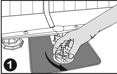
1 Remove the filter by turning it in the direction of the arrow. / Entfernen Sie den Filtereinsatz, indem Sie ihn in Pfeilrichtung drehen.
