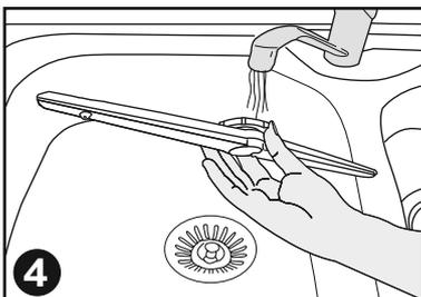
4 Clean the clogged holes under running water. / Reinigen Sie verstopfte Öffnungen unter fließendem Wasser.
