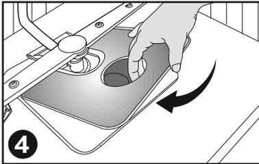
4 Install the strainer. / Setzen Sie das Sieb an.
