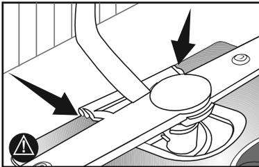
5 Make sure that the strainer fits under the plastic part. / Stellen Sie sicher, dass sich das Sieb unter der Plastikabdeckung befindet.
