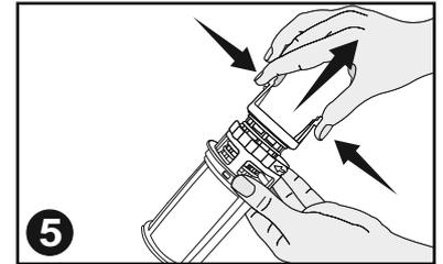
6 Press the two clips on the coarse filter inwards to take it out of the microfilter. / Drücken Sie die zwei Griffe am Grobfilter nach innen, um den Mikrofilter herauszunehmen.
