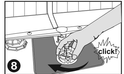
9 Install the filter and turn clockwise until you hear a click sound. / Setzen Sie den Filtereinsatz wieder ein und drehen Sie ihn nach rechts, bis ein "Klicken" zu hören ist.
