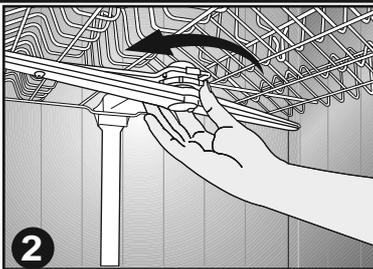
2 Turn the nut of the upper spray arm to the left and remove it. / Drehen Sie die Mutter des oberen Sprüharms nach links und nehmen Sie den Sprüharm ab.
