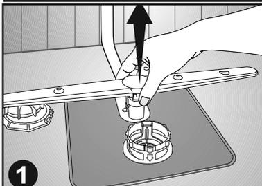
1 Lift the lower spray arm upward to take it out. / Entnehmen Sie den unteren Sprüharm nach oben.
