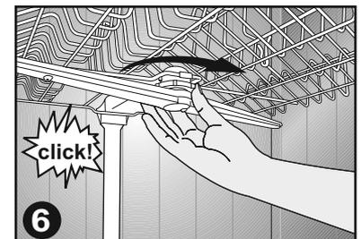
6 Install the upper spray arm. Make sure that the nut is tightened well when installing it. / Setzen Sie den oberen Sprüharm wieder ein. Stellen Sie sicher, dass die Mutter fest angezogen ist.
