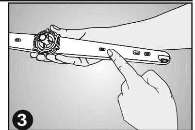
3 Check the holes of the spray arm. / Überprüfen Sie die Öffnungen in den Sprüharmen.
