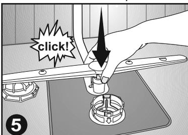
5 Install the lower spray arm. / Setzen Sie den unteren Sprüharm wieder ein.
