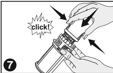
8 Place the coarse filter into the microfilter until it 'clicks'. / Den Mikrofilter in den Grobfilter einschieben, bis er einrastet und Sie ein "Klicken" hören.
