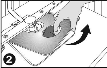
2 Pull and take out the strainer. / Entnehmen Sie das Sieb.
